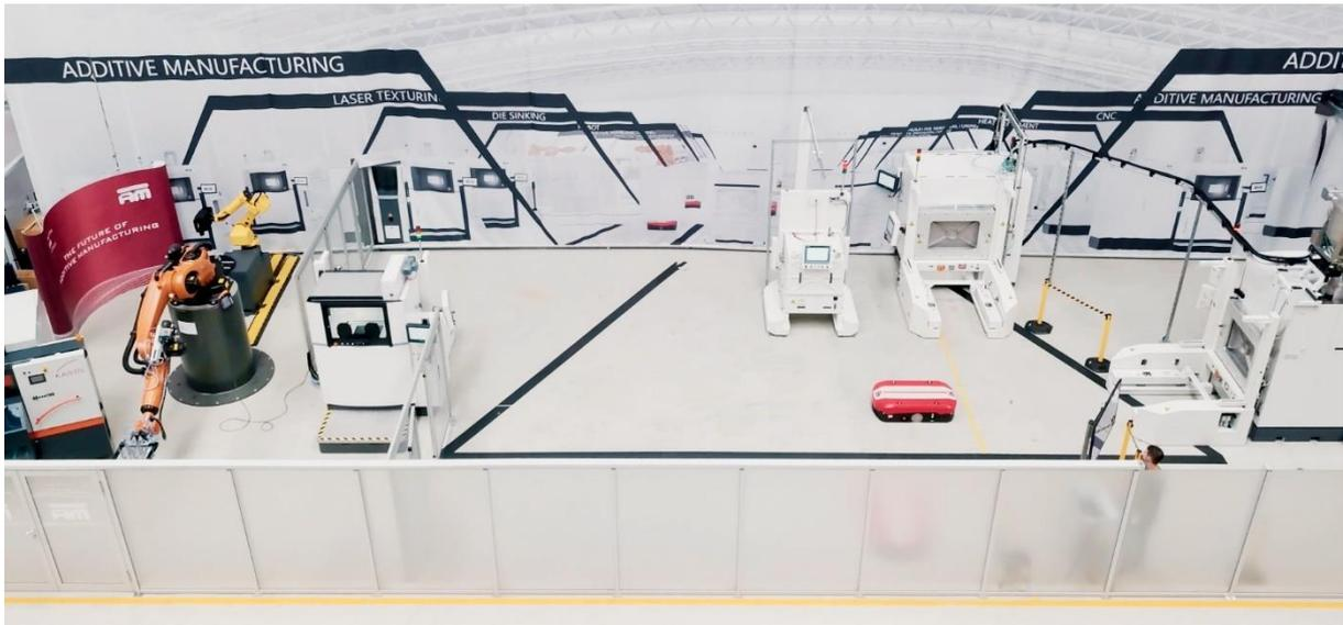
用于自动化增材制造的“新一代增材制造”项目（NextGenAM）试点工厂详细信息，从左至右：带锯、库卡（Kuka）机器人；后方：三维光学测量系统、工作准备站、拆包站；前方：自动导引车（AGV）、EOS M 400-4；不在图片内：EOS IPM M 粉末处理站（来源：EOS）
